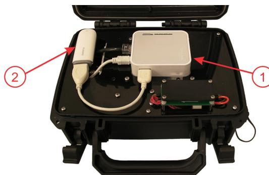
*Vista do interior do Módulo Processamento: 1) Roteador Wi-Fi; 2) Local para instalação e conexão de modem 3G/4G (conforme mostrado na imagem)*
