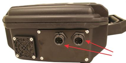
*Lateral esquerda da Maleta (destacando a conexão dos iluminadores ITSLUX)*
