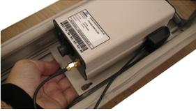
4. Instale a antena GPS de cabo longo na superfície externa da Caixa de Proteção
