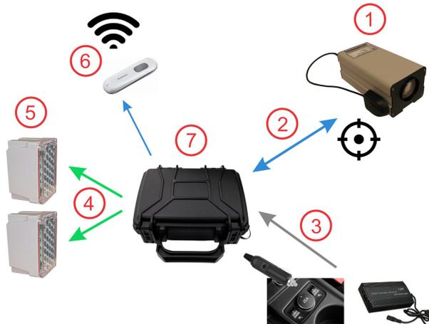
1) ITSCAM; 2) Conexão de rede; 3) Conexão de alimentação (Acendedor de Cigarro ou Fonte Adicional AC-DC); 4) Acionamento (Trigger) do ITSLUX; 5) ITSLUX; 6) Conexão de Dados 3G/4G (caso seja utilizada); 7) Módulo Processamento
