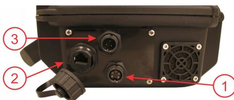
*Lateral direita da Maleta: 1) Conexão da ITSCAM; 2) Conexão de Rede Ethernet; 3) Conexão de Alimentação 12Vdc*
